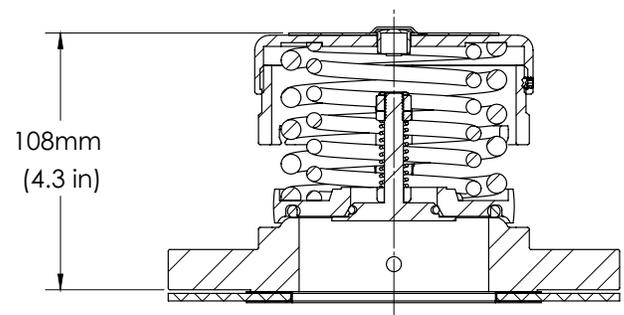
图示为压力/真空组合泄压孔
